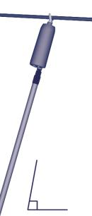
Em caso de uso temporal abaixo de chuva, o detector de tensão deve ser previamente limpo (álcool ou produto detergente). Não utilizar o aparelho se estiver com gelo; limpe-o em caso de formação de embaciamento.
